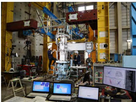
写真1 鉄筋コンクリート柱梁部分骨組の実験
