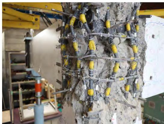
写真2 柱梁接合部の軸崩壊
