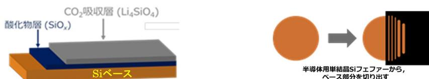
図 1 Si 板をベース部分にした自己発熱型  $\text{CO}_2$  吸収コンポジットと半導体用 Si ウェファーから短冊状に切り出したベース部分に使用される Si 板のイメージ図
