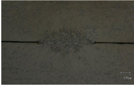
図 8 レーザ分岐による亜鉛めっき鋼板 レーザ重ね溶接部の断面観察結果
