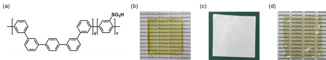
図 1 (a) SPP-QP の化学構造、(b) SPP-QP 薄膜、(c) PE7 基材、(d) SPP-QP-PE7 薄膜
