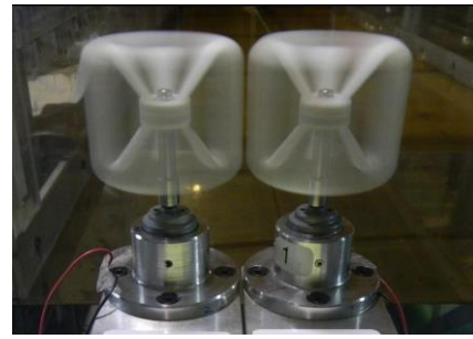
図2 風車ペアの風洞実験
