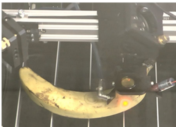
図1 青果物へのレーザー印字の様子
