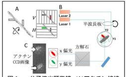
図1.一分子偏光顕微鏡。(A)アクチン線維に量子ドットをつける。×方向の偏光では緑で示す量子ドットが検出され、y方向の偏光では赤で示す量子ドットが検出される。ねじれ揺らぎがあると両者は入れ替わりねじれの大きさを評価する。(B)一分子偏光イメージングの装置の概念図。xy二方向励起光(Y1 Y2)の偏光面は半波長板を回転して変化させる。蛍光の×偏光y偏光は方解石で分け CCD で撮影。(C)アクチン線維の蛍光画像の例。矢印は同じ輝点を示す。
