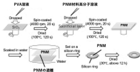
図4 スピコート法によるPNMの調製
