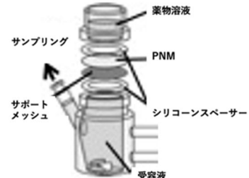
図5 透過実験装置
