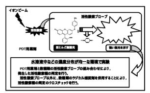
薬剤を数種類使用する。イオンビームとPDT用薬剤との相互作用によって発生する活性酸素種を同定するため、活性酸素種を効率よく検出するための市販の蛍光試薬(活性酸素プローブ)を使用する。サンプルはPDT用薬剤に活性酸素プローブを添加したものを使用し、粒子線照射後、水溶液サンプル中の活性酸素プローブの発光スペクトル及び発光強度を測定することにより活性酸素種を同定する。
