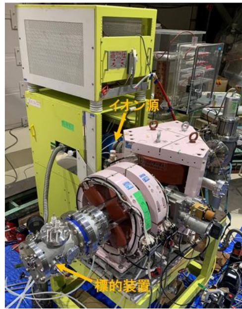
図 9: 小型イオン源を利用した RI 生成検証装置。
