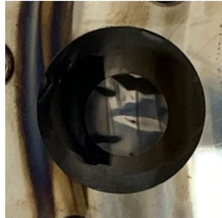
図 10: 変形した Ni 箔。画像中央の箔部分に、ビームが部分的に当たっている痕が見られ、また波打ったように変形しているのが見て取れる。変形はしているが破れてはいない。
