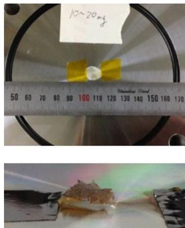
図 7: deuterated polyethylene のビーム照射前後の様子[5]
