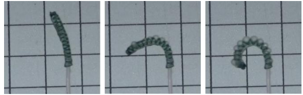
図8 ハイブリッド構造の湾曲アクチュエータ 図9 ハイブリッド構造のアクチュエータの動作の様子
