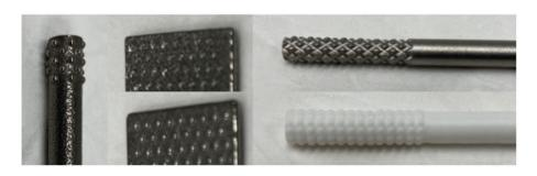
3D プリントで表面が全体的にざらざらした正常のものでは、突出や陥凹部分を付けた部分もそれ以外の部分も同様に比較的明瞭に描出され、超音波が斜めに入射しても同様であった。また、音響陰影はあるものの、多重反射やサイドローブなどのアーチファクトは生じていなかった。一方、光沢仕上げしたステンレスの試料では、凹凸のある先端部分は顕著なサイドローブを生じ、光沢部分では、超音波と直交する部分から幅広い多重反射を生じ、そこにあるものが
