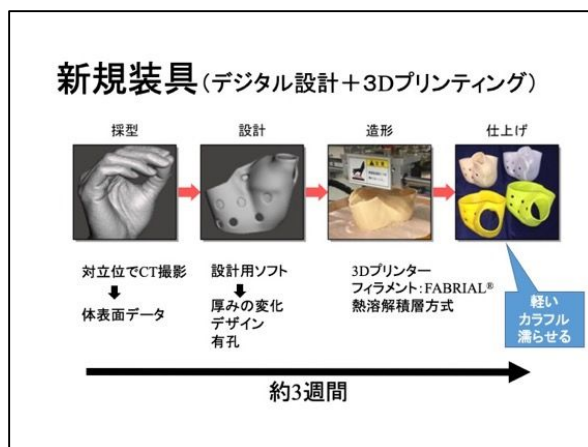
図 3 3D プリンティング装具の製造過程
