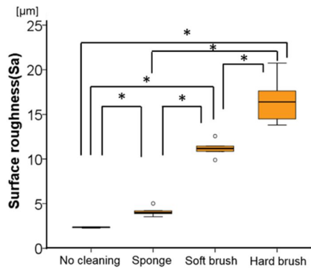
図2 . 歯ブラシ磨耗試験(高ショア A 硬さ) 図3 . 歯ブラシ磨耗試験(低ショア A 硬さ)
