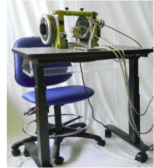
図1 ポータブル L-band EPR 生体線量測定装置
