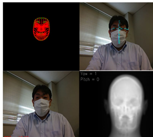
図 2 仮想骨格 X 線撮影システム
