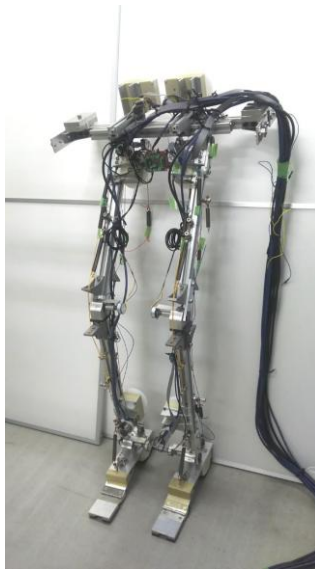
図2 開発された実歩行可能な筋骨格型 ロボット歩行シミュレータ
