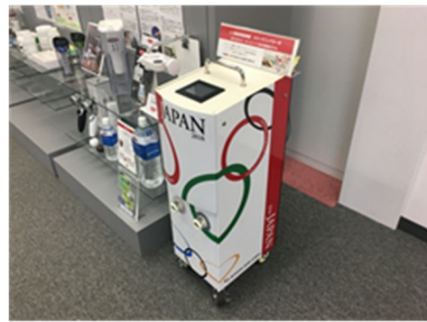
図2. 人工炭酸泉製造装置 2016リオデジャネイロオリンピックモデル（SC401）
