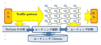
トラフィックパターンの変化にロバストな NoC システムの構成イメージ
