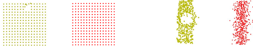
図7 点群データにおける欠損補間
