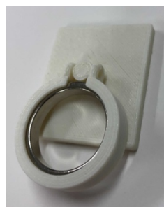
図3 スマホリング型操作デバイス。リングはネオジム磁石でできており、スマートフォン本体の磁気センサーで回転角度を計測する。
