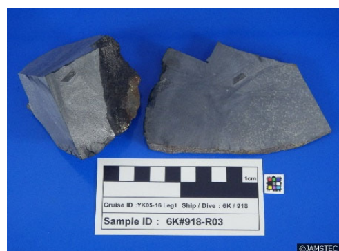
図 1. 水熱反応実験で用いた岩石試料。インド洋熱水域から採取された火成岩（枕状溶岩）6K#918-R03（試料および写真提供 JAMSTEC）
