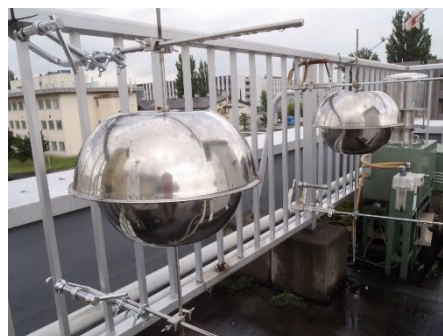
図 1 : PUF を用いた UFO 型パッシブサンプラー
