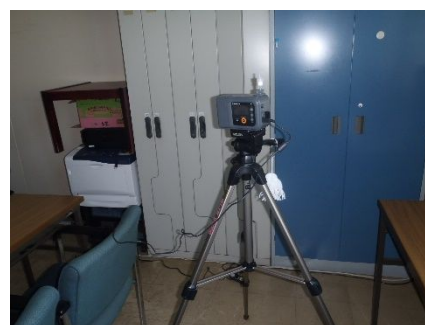
図 2 : アクティブサンプリングとパッシブ法との並行測定の様子
