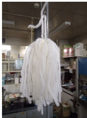
図3：毛糸を捕集材としたパッシブサンプラー
