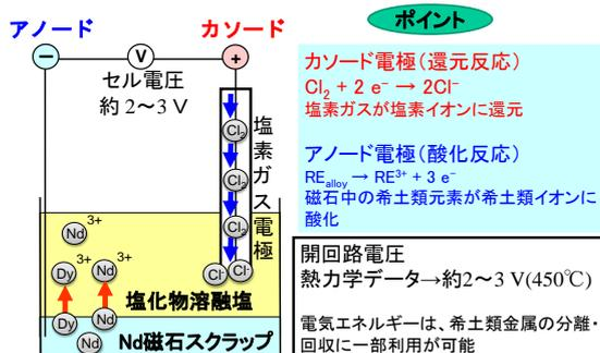
図1 電池反応を利用した省エネルギー型希土類金属リサイクルプロセスの開発
