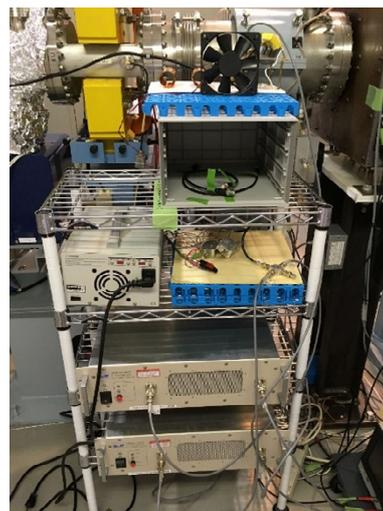
図 11 . WERC シンクロトロンの RFKO 電極に接続したマルチバンド RFKO システム。
