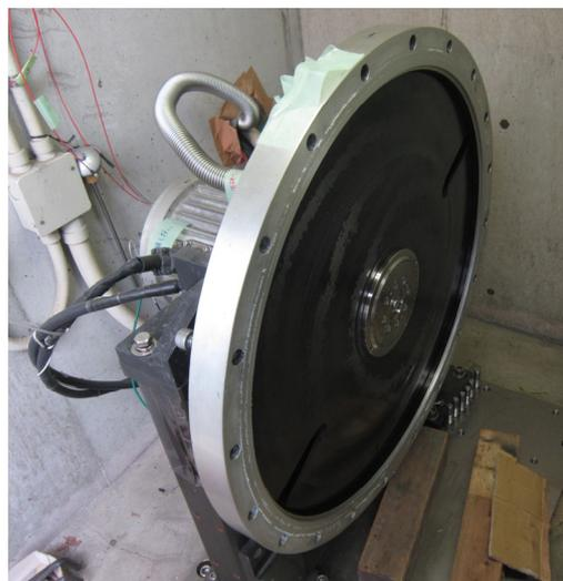
図4 完成した検証実験用の多孔ディスク。2つのスリットを持つ。ディスクの性能試験用の回転装置に装着された状態。
