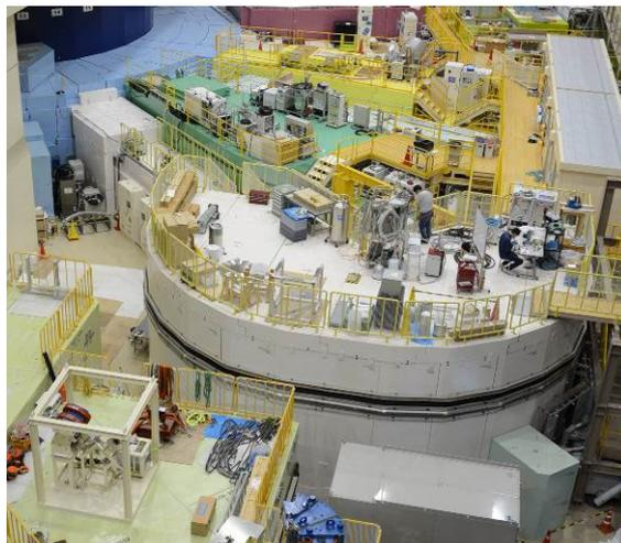
図1 最新世代の中性子実験施設の1つであるJ-PARCに設置されている中性子分光器AMATERAS
