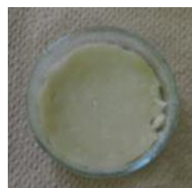
図 2 シャーレ上に作製したエラスチン材料
