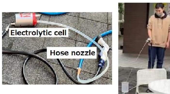
図3 流水型オゾン水生成装置 Ver.1 とオゾン水放水実験
