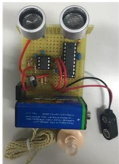
図 8 開発した障害物検知装置の一例
