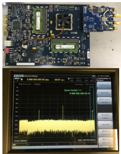
図 2 本研究で用いた評価ボードと得られたスペクトル。6 GHz の周波数を直接合成することができた。
