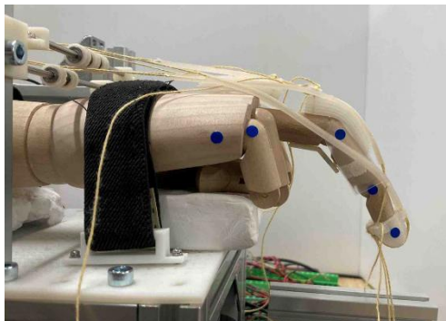
図 3. 指のモデル上に配置された腱を用いた力覚提示装置
