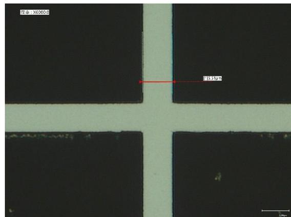
図4. 印刷法で形成された銀電極（線幅 5.5 μm）
