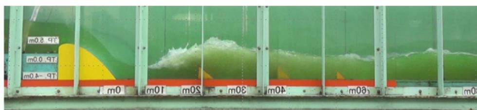
写真-1 計画流量 11,000m<sup>3</sup>/s を想定した新第二床固大型水理模型実験の流況
