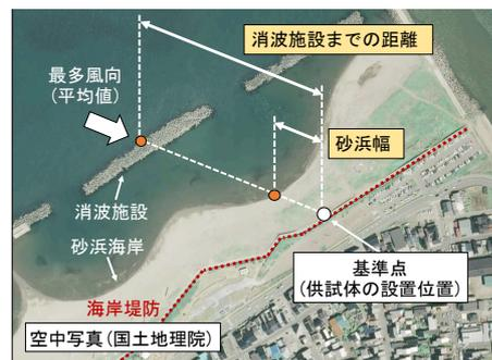
図6 消波施設距離と砂浜幅の測定方法
