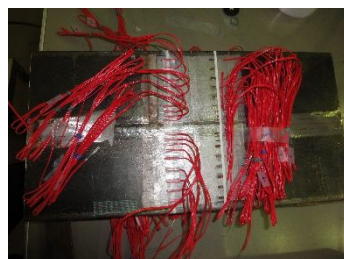
図 4 切り出し法 (切断前)
