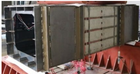
図8 ボックスガーダーの4点曲げ試験
