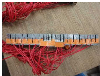
図 5 切り出し法 (切断後)
