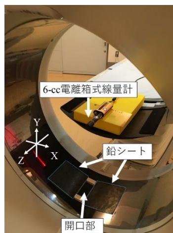
図 1 Z 軸方向のビーム幅および回転速度に影響しない出力の測定方法
