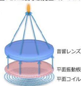
図1 ESWL衝撃波発生メカニズム
