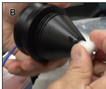
図 4. 衝撃波強度測定環境 (A 衝撃波測定チャンバー B ハイドロフォン C オシロスコープ)
