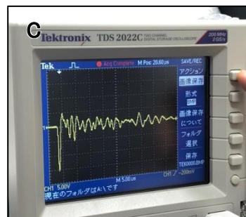
図 4. 衝撃波強度測定環境 (A 衝撃波測定チャンバー B ハイドロフォン C オシロスコープ)
