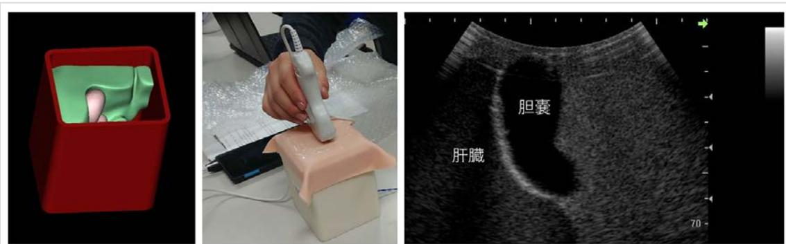
図1) 3Dデータ（左図）、シミュレータ試作機（キューブおよび圧センサー機器）（中図）、試作機のエコー画像（右図）
