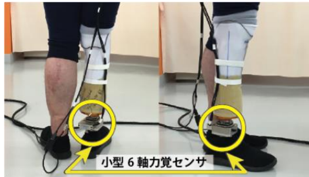
図 2 小型 6 軸力覚センサ設置位置
