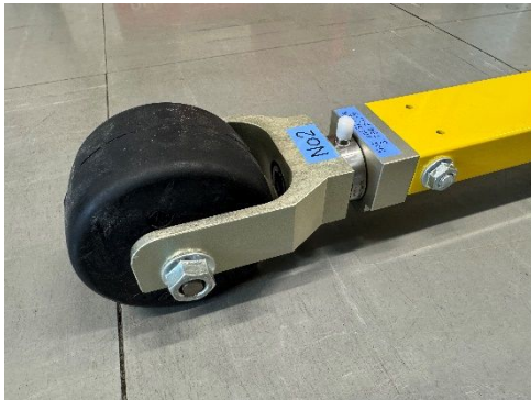
図．力センサを内蔵したローラースキー
