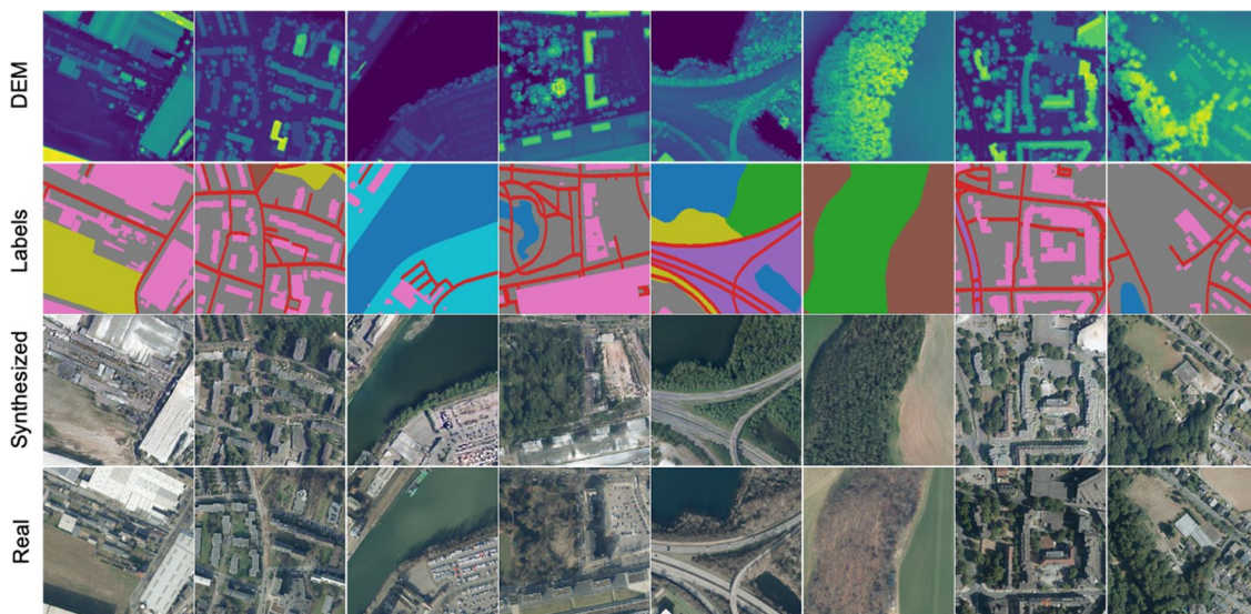
図1 デジタル標高モデル(1行目)と土地被覆分類マップ(2行目)を用いた合成画像(3行目)と実画像(4行目)
