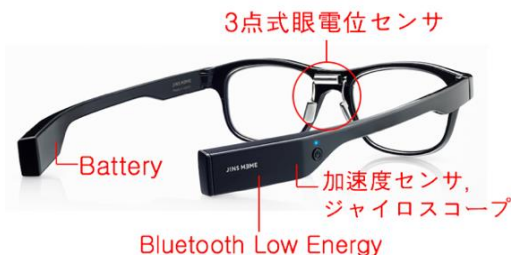
図1. 申請者が開発に関わったメガネ型ウェアブルデバイス。鼻パッド部分が電極になっており、皮膚表面の眼電位の変化から眼球運動を捉える。
