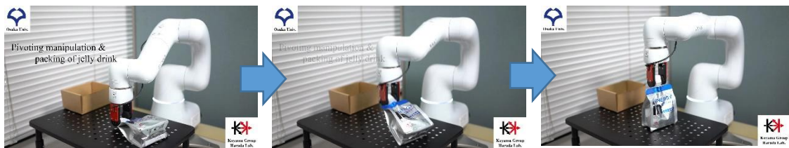
図 3: 近接覚センサフィードバックに基づくゼリー飲料の回転操作の様子
