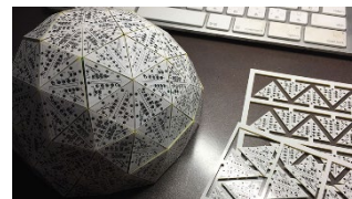
図4. 基板によるジオデシックドーム
