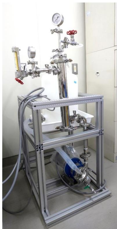
図 1: 本研究で開発した中規模限外濾過システムの外観
