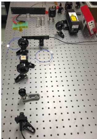
図 3 プローブレーザーおよび測定光学系
