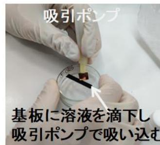
図2. 分子層成膜の制御のため、窒素雰囲気湿度ゼロ環境を準備した。また、成膜再現性を高めるため、吸引ポンプで液滴を引く速度を一定化した。
