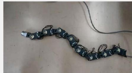
最終的には研究開発領域 (4) 【全開発項目実装と実証実験】として上記で開発した2つの機構を地中ドローンのプロトタイプに実装し、実砂槽・スラリー槽にて自由に移動が可能であるか検証実験を行った。結果として本助成期間中では掘削部分と推進部分の相互作用の最適化が実現できず、双方の部分最適に止まった。しかしながら、以下の実験結果に示すとおり、へび型推進機構によるスラリー内の自由な移動を実現し、掘削部分の小型化により本構想の完全な実現が可能である見通しを得た。また、テーリングダムでの調査を視野に入れた自己位置推定とRGB-Dカメラを用いた遠隔操作のための第三者視点提示を開発するに至った。ここで得られた要素技術および実験結果は、今後の実テーリングダムでの実用のために活用されていく。
