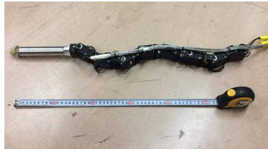
制御系では、研究開発領域 (3) 【機械学習による制御系設計とモータートルク分配の最適化】として、機械学習により関節角・モータートルクの制御を行った。シミュレータで得られた計算値を初期値として、実際の砂槽
