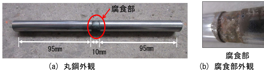
図-9 腐食を模擬した丸鋼概要
