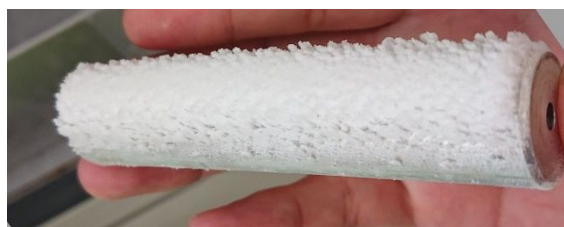
図5 庫内温度 -20 での着氷実験終了後の円柱表面の着氷
